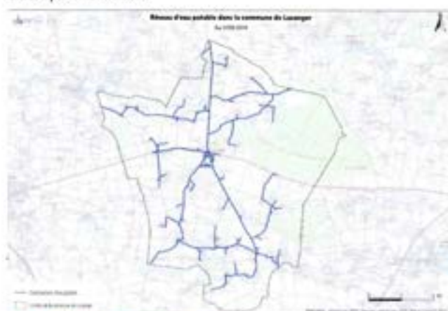
Figure 34 : Réseau d'eau potable de Lusanger Source : Atlantic'eau 2019
